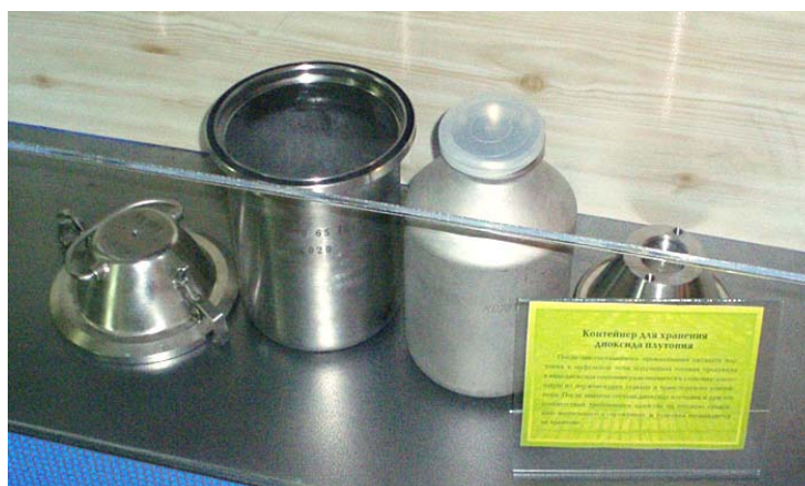
Рис.5. Контейнеры для плутониевых материалов скрапа
