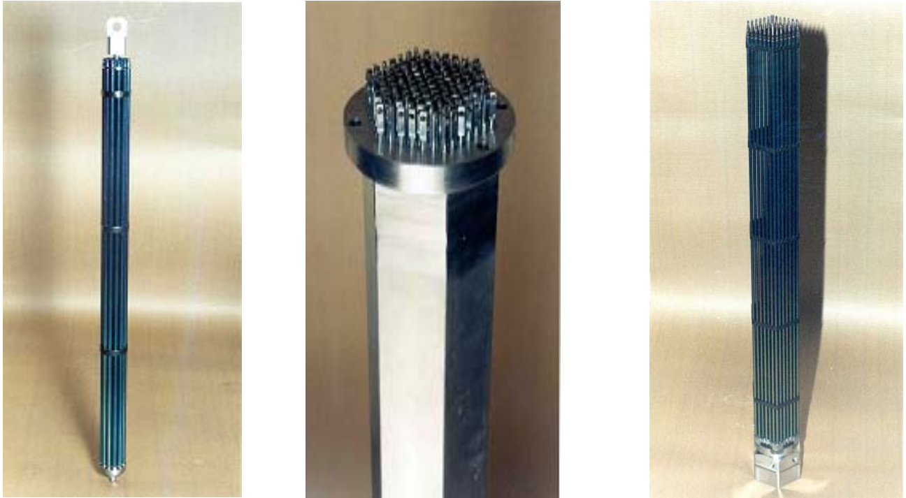
Рисунок 7 – Стандартные образцы ТВС реакторов РБМК, БН-600 и ВВЭР-440.
