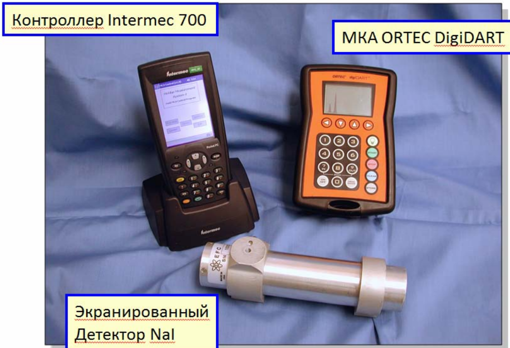
Рисунок 1. Компоненты базового комплекта системы HMS-4.
