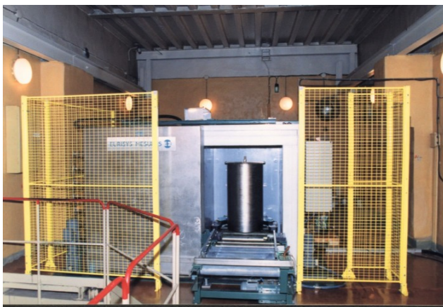
Рисунок 2 – Установка для измерения массы плутония в бочках с отходами.
